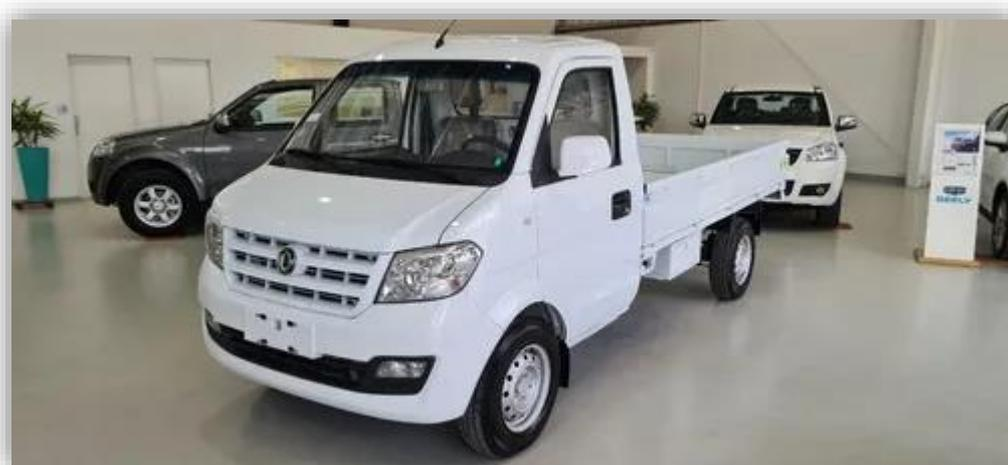
La misma es un mini truck cabina simple que ofrece comodidad y practicidad en un camión de tamaño chico que soporta hasta 1.500 kg. Las dimensiones de la misma son 4.8m de largo, 1.6 m de ancho y 1.9m de alto.
