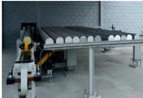
Ilustración 21 Sistema para cargar los tochos
