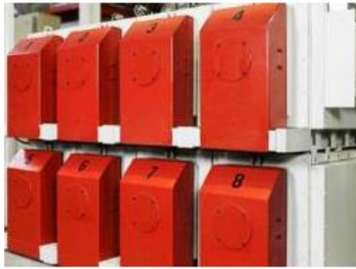
Ilustración 27. Estufas calentamiento de matrices
