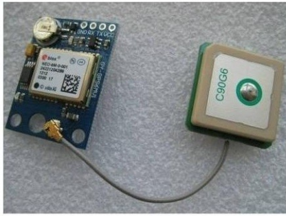
Fig. 5 Modulo GPS Ublox Neo6 Antena Activa Alta Sensibilidad
