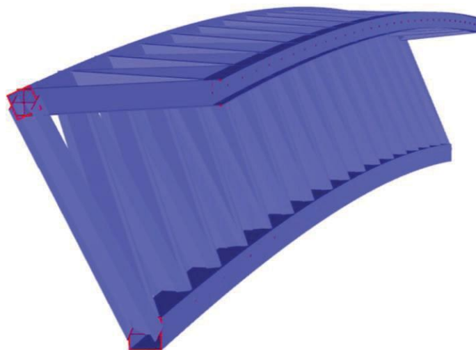
61 - Vista del modelo de cálculo de una de las vigas principales.
