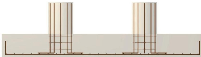
162 - Vista lateral de la cimentación de 3 pilares.
