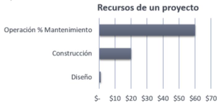
Figura 54 – Relación de recursos empleados en fases de diseño, construcción y operación/ mantenimiento.
