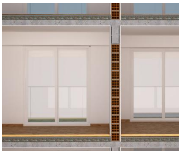
Figura 40 – Detalle constructivo y propiedades físicas de mampostería interior.
