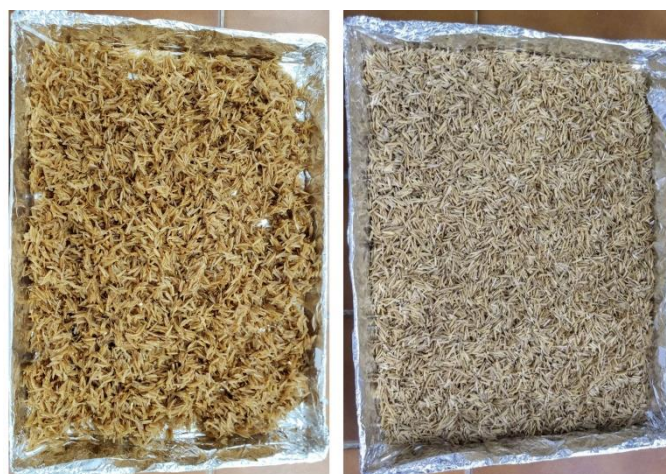
Figura 1. Cascarilla de arroz. Imágenes luego del lavado y secado en estufa.
