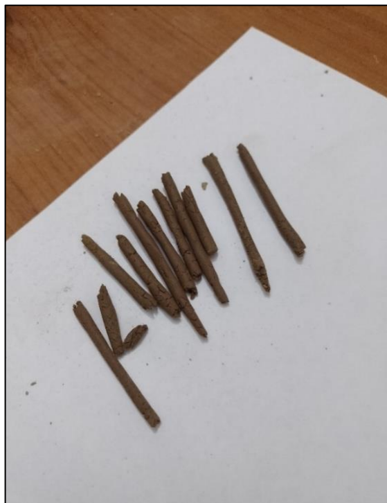
Figura 5.12 – Cilindros de suelo para ensayo (límite plástico)
