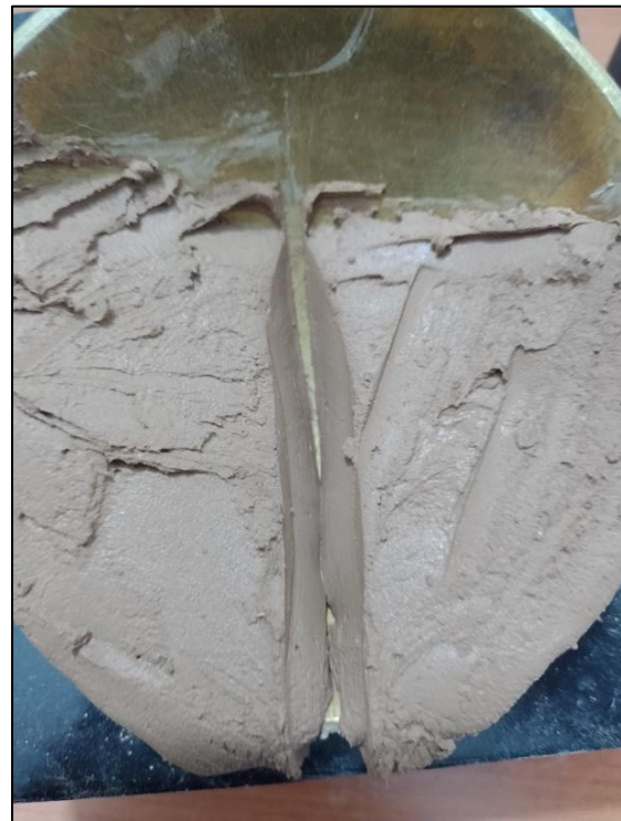
Figura 5.11 – Muestra de suelo posterior a ensayo (límite líquido)
