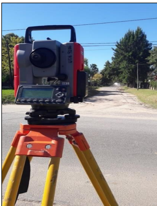
Figura 4.16 – Trabajo de relevamiento topográfico con estación total
