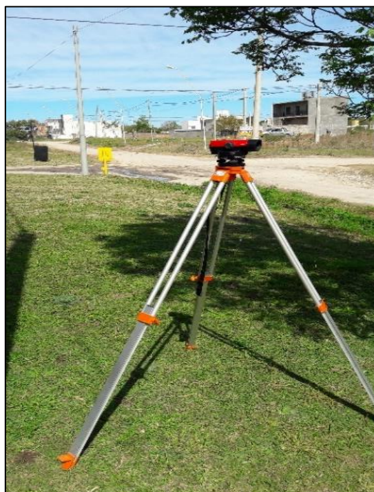
Figura 4.17 – Trabajo de nivelación compuesta con nivel óptico
