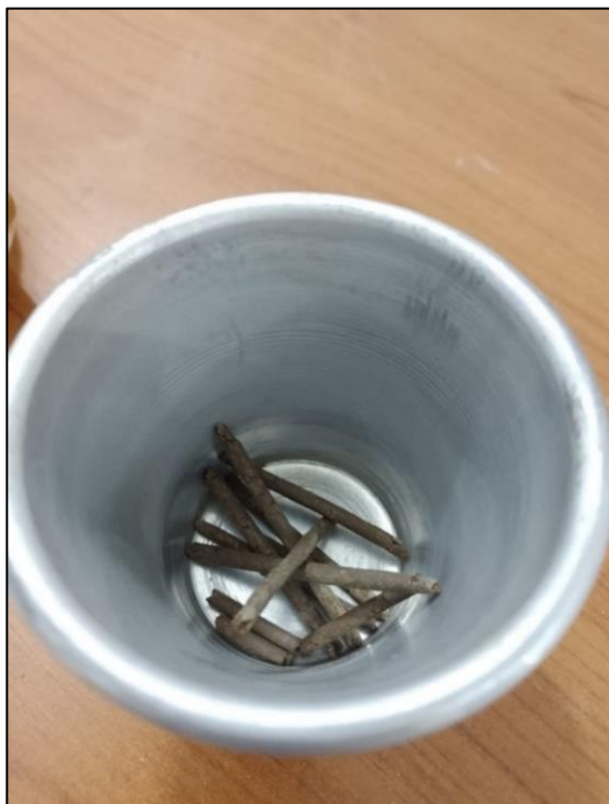
Figura 5.13 – Cilindros de suelo secados en horno para ensayo (límite plástico)
