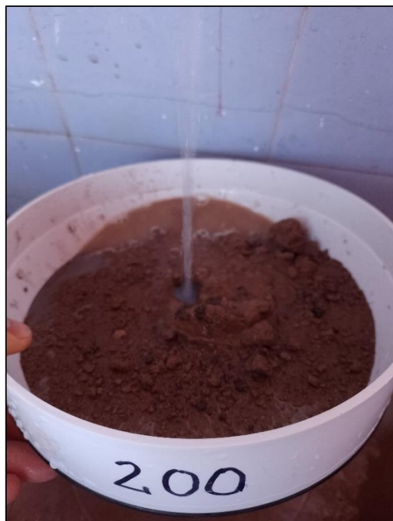
Figura 5.8 – Lavado de muestra de suelo sobre tamiz IRAM N°200
