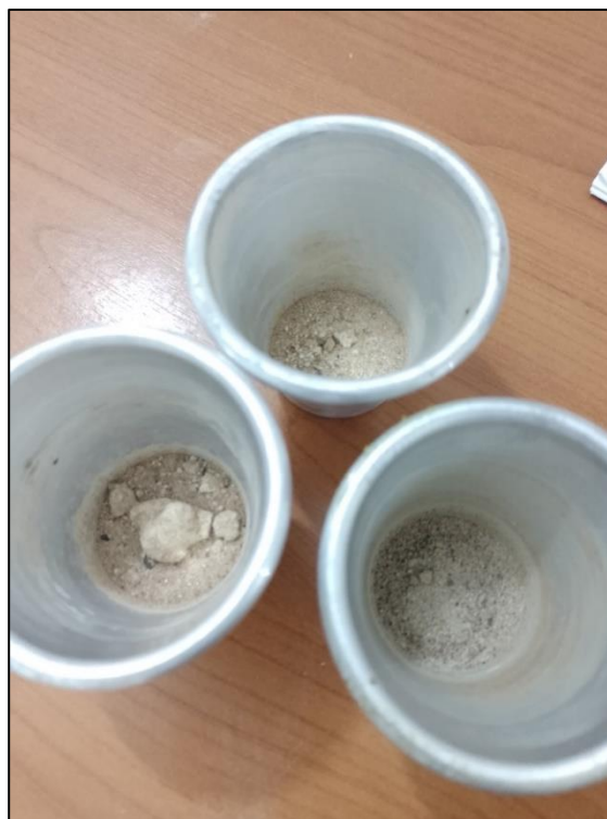
Figura 5.9 – Muestras de suelo secadas a estufa
