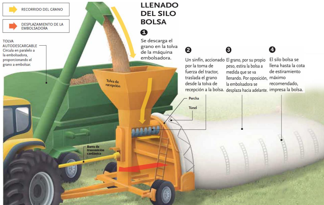
Figura 1. Proceso llenado silo bolsa
