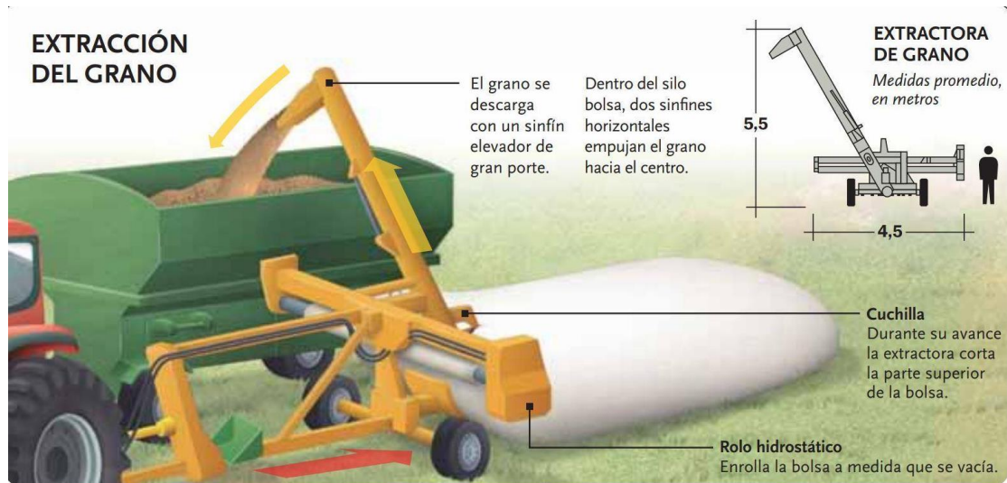
Figura 2. Proceso extracción de granos
