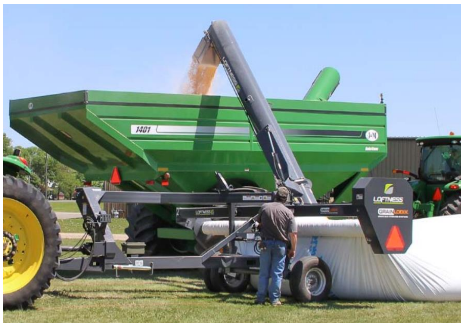
Figura 6. Extractora modo trabajo
