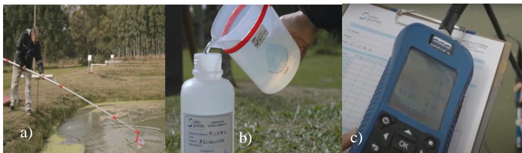
Fig. 1: a) Extracción de muestra medio de crianza en la Estación de Acuicultura Salto Grande (EASG) con caña telescópica, b) traspaso de muestra a envase esterilizado y c) sonda multiparamétrica.
