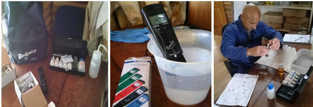
Fig. 3: a) Mochila de campo y sus elementos b) equipo portátil y c) proceso de análisis de los parámetros realizados con el Test Kits Químicos.
