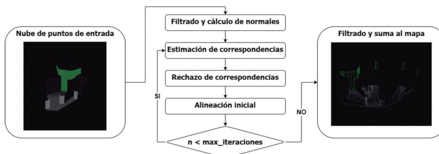
Fig. 3. Diagrama en bloques del pipeline realizado para el registro de nube de puntos tridimensionales y su posterior actualización del mapa 3D
