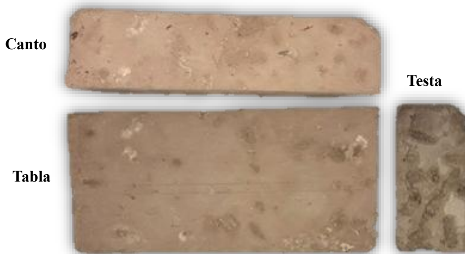
Figura 29. Condiciones físicas de adobe de T-C-M a los 28 días de edad.
