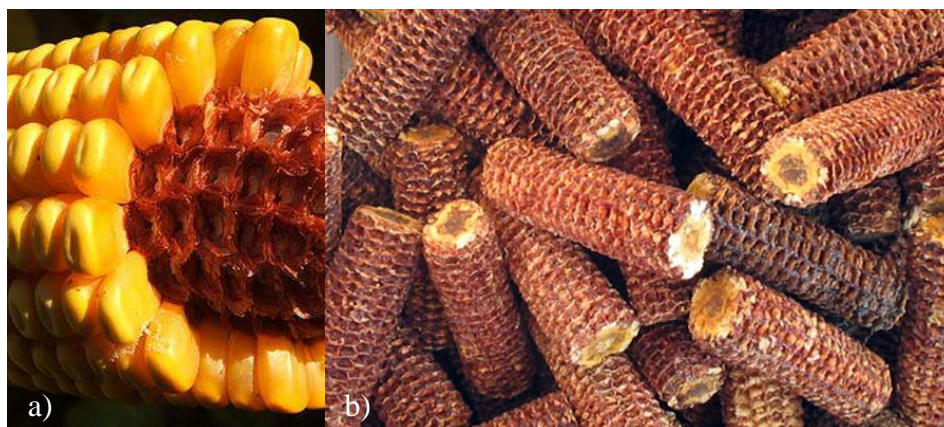
Figura 3. Marlo de maíz en estado natural: a) con granos de maíz-, b) Marlo pelado.
