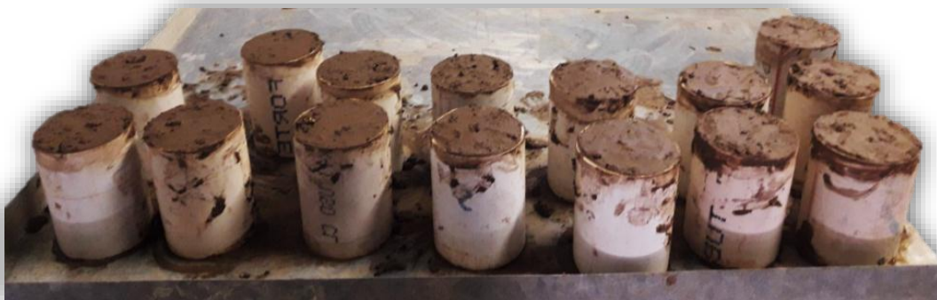
Figura 14. Curado inicial de las probetas.
