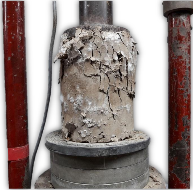
Figura 18. Falla de probeta.
