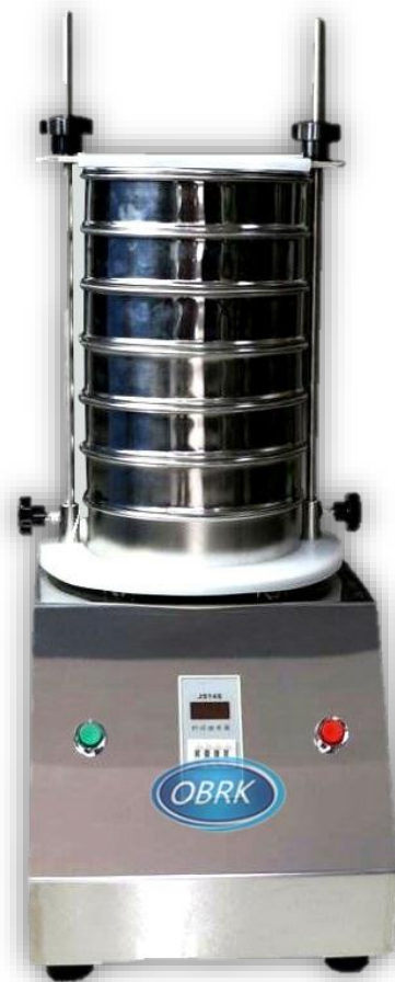
Figura 9. Equipo utilizado para el ensayo granulométrico.
