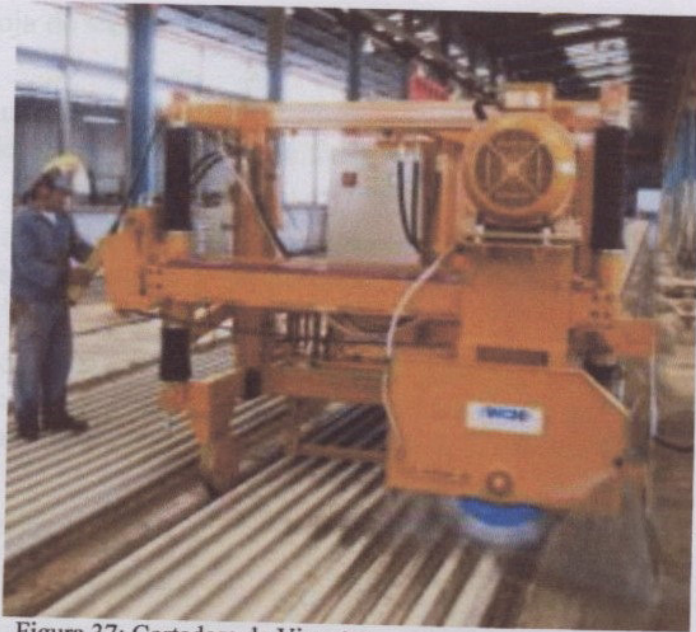
Figura 37: Cortadora de Viguetas.
