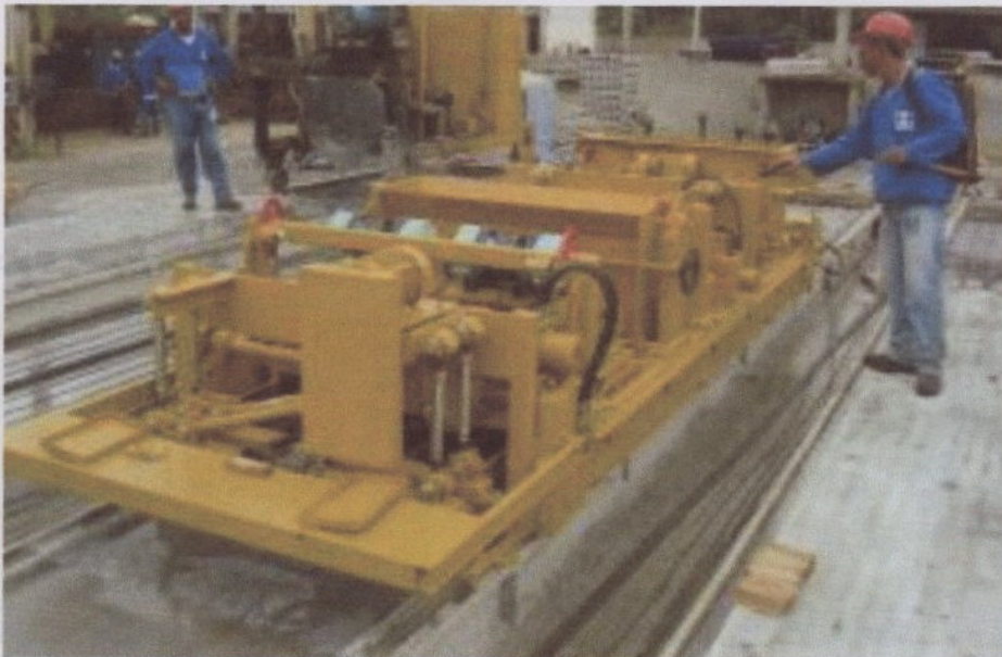
Figura 35: Moldeadora de Complementación.
