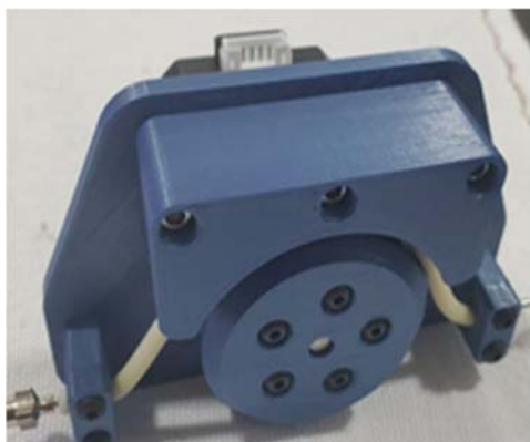
Fig. 2. Bomba peristáltica desarrollada para el prototipo de titulador
