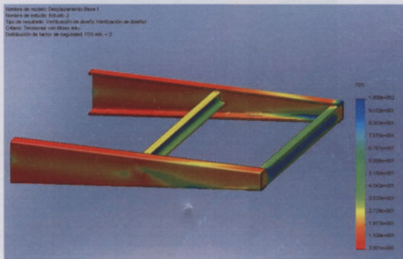
Ilustración 16: Factor de seguridad de la base de la arcata
