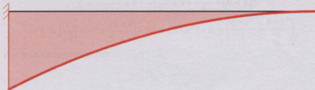
Ilustración 5: Diagrama de momento flector
