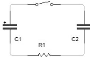
Fig. 250. Estudio del estado transitorio con redistribución de cargas entre capacitores, donde el  $C_1$  originalmente cuenta con carga y el  $C_2$  se encuentra descargado.
