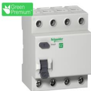
Interruptor Diferencial Easy9 4P 63A 30MA Clase AC
