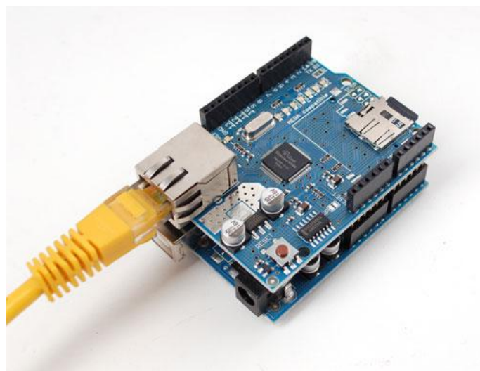
ILUSTRACIÓN 22-ETHERNET SHIELD W/MICROSD CARD READER (WIZNET W5100 ETHERNET CONTROLLER)
