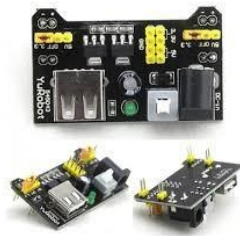
Figura N° 35 Fuente de alimentación MB-102
