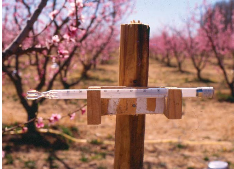
Figura N° 8 Termómetro de mínima en un monte de duraznero en floración
