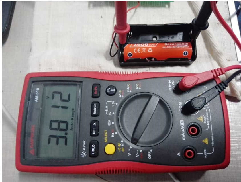
Figura N° 125 Tensión de las baterías antes de ser cargadas
