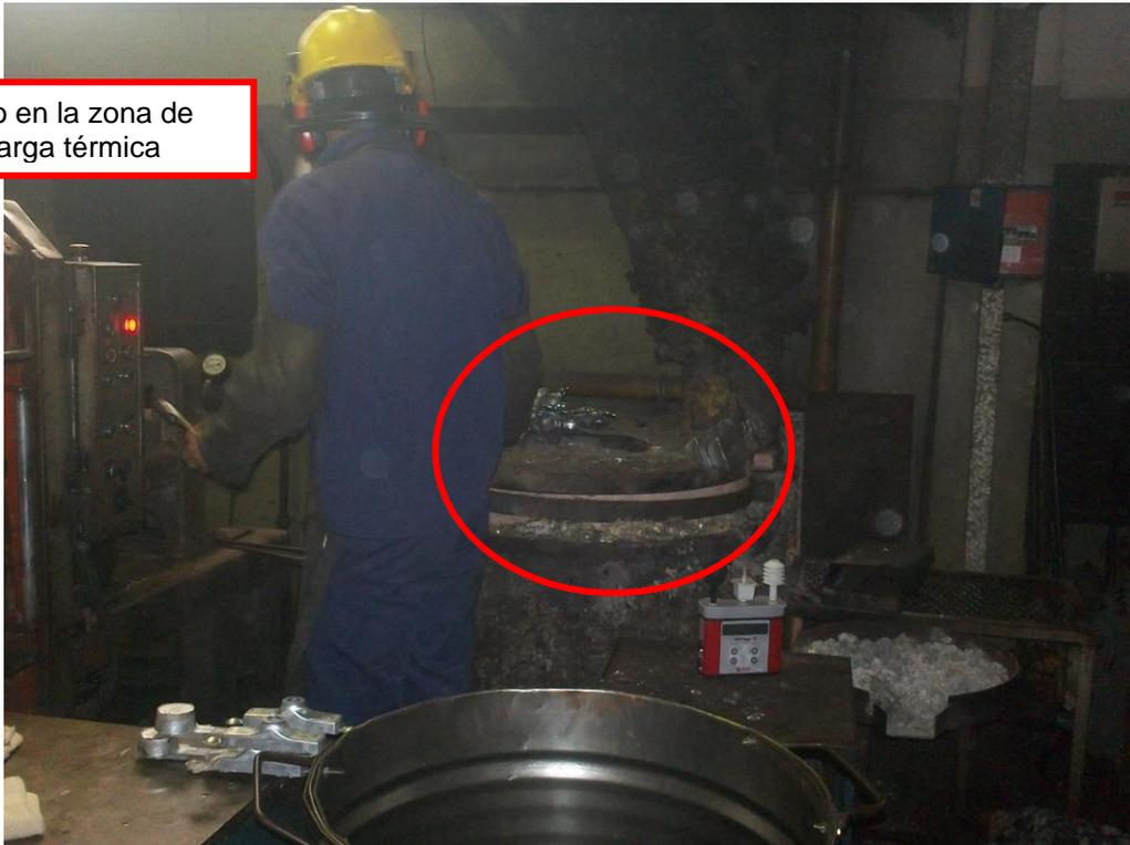
Operario dosificando nitrógeno para enfriar y despegar la pieza inyectada luego de darle la forma deseada
