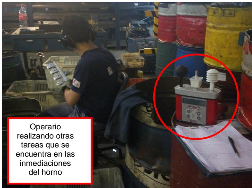
**Imagen real extraída de una medición de carga térmica realizada en una empresa, se observa al operario desarrollar las actividades en las inmediaciones del horno de fundición.**
