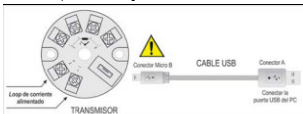
Fig. 2 – Conexiones del cable USB – Alimentación pelo loop
