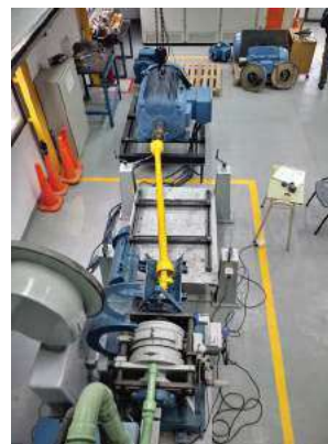
Fig. 1. Ensayo del acoplamiento al dinamómetro.
