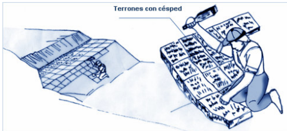
Colocación de panes de césped
