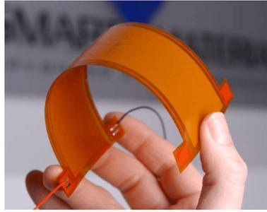
Figura 2.7: Actuador de electrodos interdigitados fabricado por *Smart Materials: Macro Fiber Composite (MFC)* [50].
