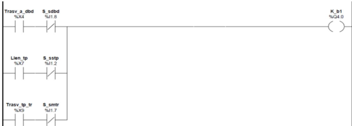
En el post tratamiento la etapa %X7 activa genera el encendido de la bomba N°1, la apertura de las válvulas del depósito de aceite (Ev\_da) y la electroválvula para el llenado del tanque de pre tratamiento (Ev\_lltp).
