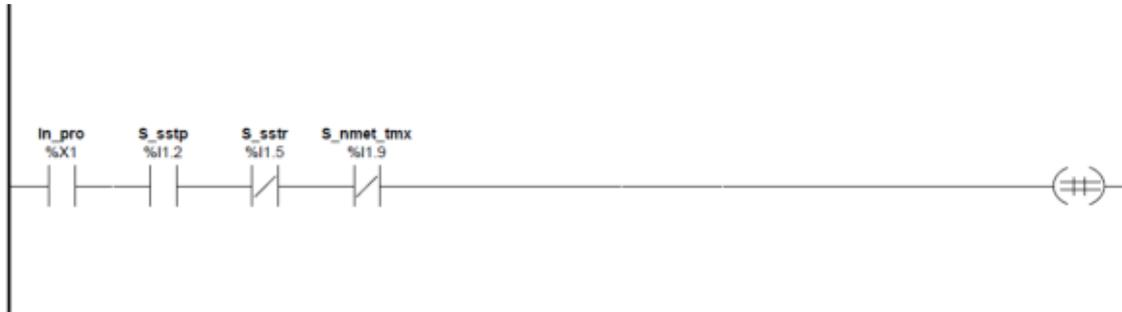
Además de los dos contactos que deben estar activos para que comience este grafcet debe estar desactivado el sensor superior tanque de reacción S\_sstr y el sensor de nivel de metanol dentro del tanque de metoxido S\_nmet\_tmx.
