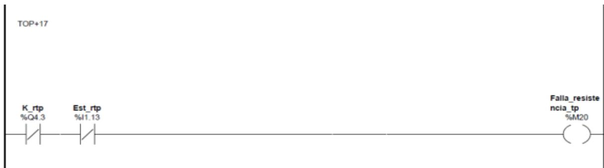
Esta línea representa que si la memoria M20 esta activa existe un problema en la resistencia calefactora. Para verificar el estado de esta resistencia, hemos colocado un relé en paralelo con la salida que enciende la resistencia.
