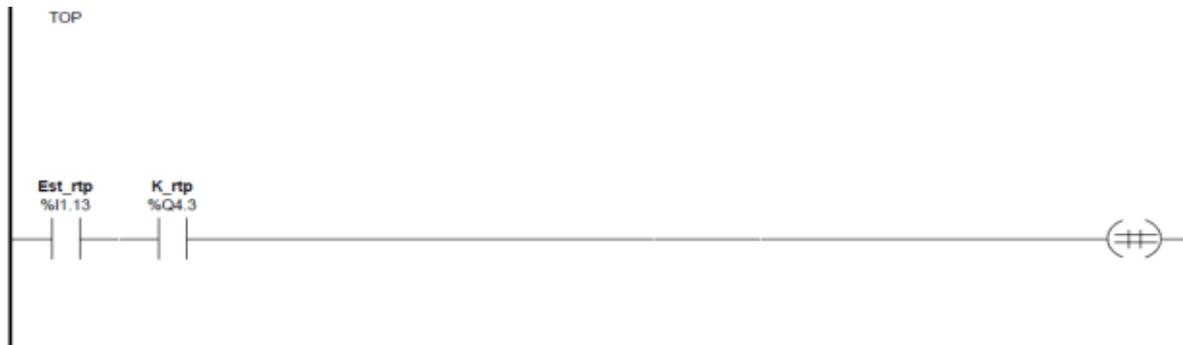
La primera alarma se activara si la resistencia calefactora se corta, en esta transición se escribimos ambos contactos activos, el primero es una entrada que se encuentra en uno si la salida que enciende la resistencia esta en cero.
