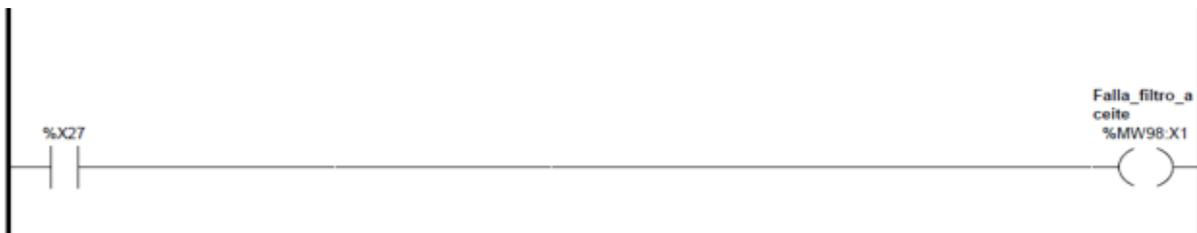
Una vez solucionado el inconveniente, oprimiendo el pulsador de reset de alarma se activa la etapa X7 nuevamente para continuar con el llenado del tanque de pre tratamiento. Si el llenado del tanque de pre tratamiento demora más que el tiempo estipulado, se produce la desactivación de la etapa X7 y la activación de la etapa X29.
