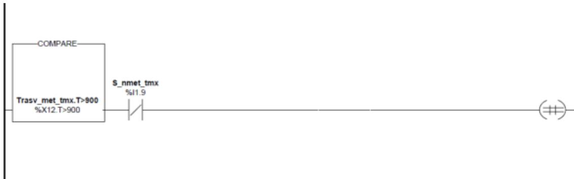
La bomba seleccionada es de 30 litros por minuto, entonces si la bomba se encuentra encendida más de 1 minuto 30 segundos y no esta activo el sensor superior del tanque TMX se produce la transición y se activa la etapa X41.
