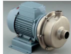
Para esta aplicación es necesaria una bomba centrífuga tipo monoblock, construida en acero AISI 316 con motor eléctrico blindado y sellos de teflón. Estas características son las requeridas para que esta bomba sea apropiada para operar con este tipo de fluidos en las condiciones establecidas.
