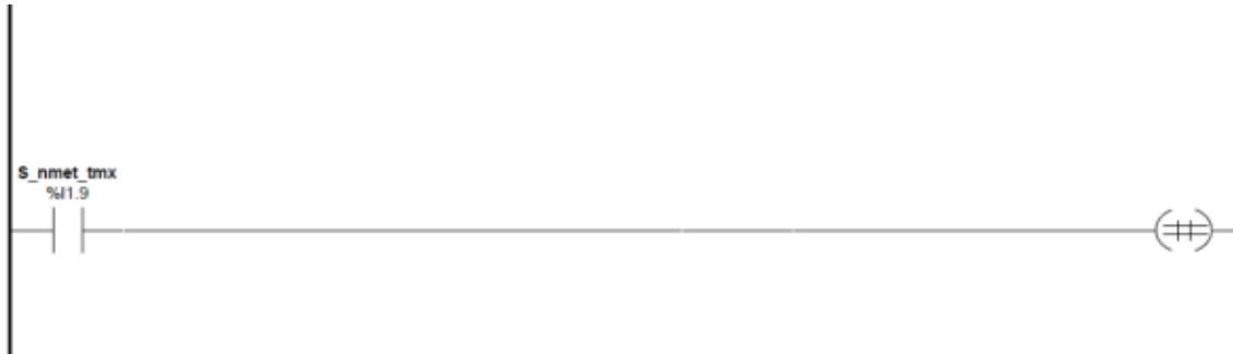
En paralelo con esta transición hay otra transición que se produce en caso de actuar el guardamotor de la bomba 2, interrumpiendo el llenado y generando una alarma en el panel de dialogo.
