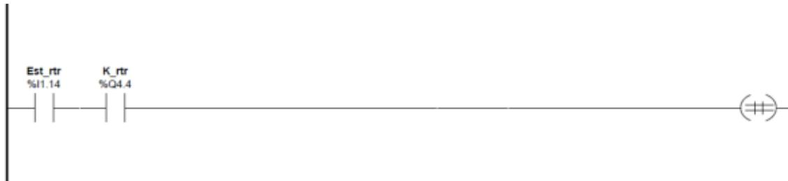
Para que esta transición se lleve a cabo se debe cumplir que este activa la entrada correspondiente al estado de la resistencia del tanque de reacción y que este activa la salida que enciende la resistencia calefactora. En caso de presentarse esta combinación se generara una alarma en el panel de dialogo describiendo esta anomalía.
