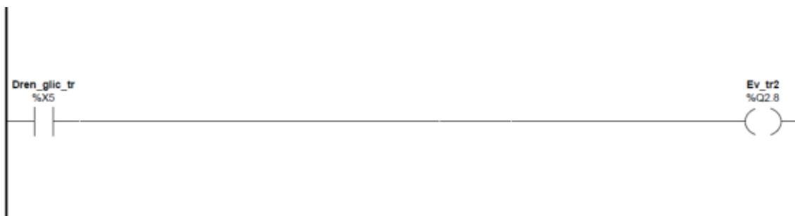
En el diagrama anterior se puede ver el tratamiento realizado en el post tratamiento sobre la etapa X5. Si esta etapa esta activa se produce la apertura de la electroválvula Ev\_tr2, ubicada en la parte inferior del tanque de reacción.
