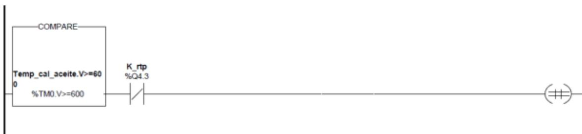
El tiempo de permanencia de esta etapa es de 10 minutos, que es controlado por el temporizador TM0. Cuando este llega a 600 bases de tiempo, con una base de tiempo de 1 segundo se produce la desactivación de la etapa X8 y la activación de la etapa X9.
