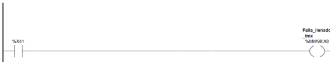
Si se presiona el pulsador reset de alarma se desactiva esta alarma y se inicia nuevamente el llenado del tanque TMX.
