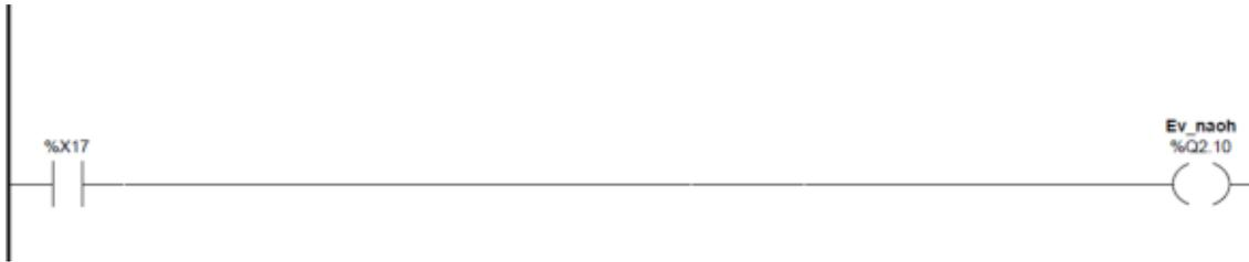
La etapa X17 se mantiene hasta que se produce la transición siguiente
