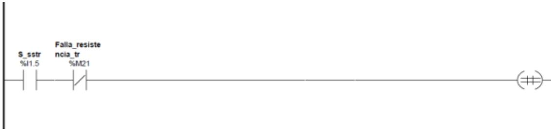
El primer contacto representa el sensor superior del tanque de reacción S\_sstr y que no exista una falla en la resistencia de calentamiento.
