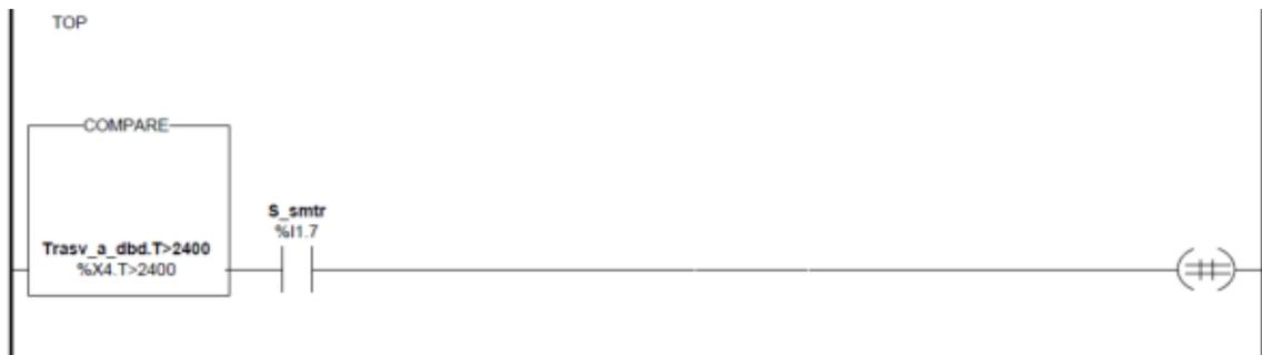
Una vez activa esta etapa se genera una alarma en el panel de dialogo. Luego, mediante la activación del pulsador de reset alarma se activa nuevamente la etapa X4 y se reinicia el trasvase.
