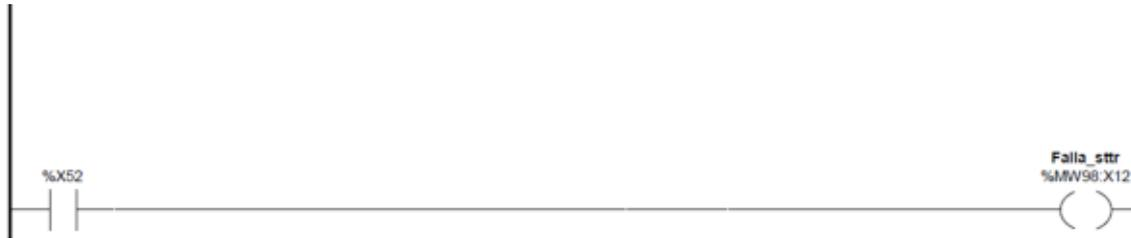
La última de las transiciones se representa si actúa el guardamotor correspondiente al motor del mezclador ubicado en el tanque de reacción.
