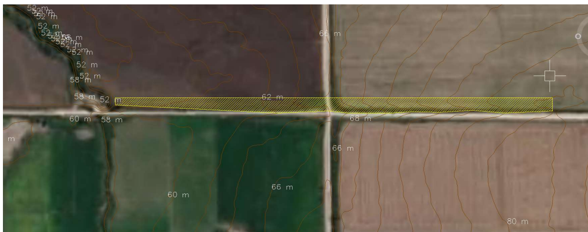
Figura 4. 22 Área en croquis de ubicación y curvas de nivel afectada a la cuneta
