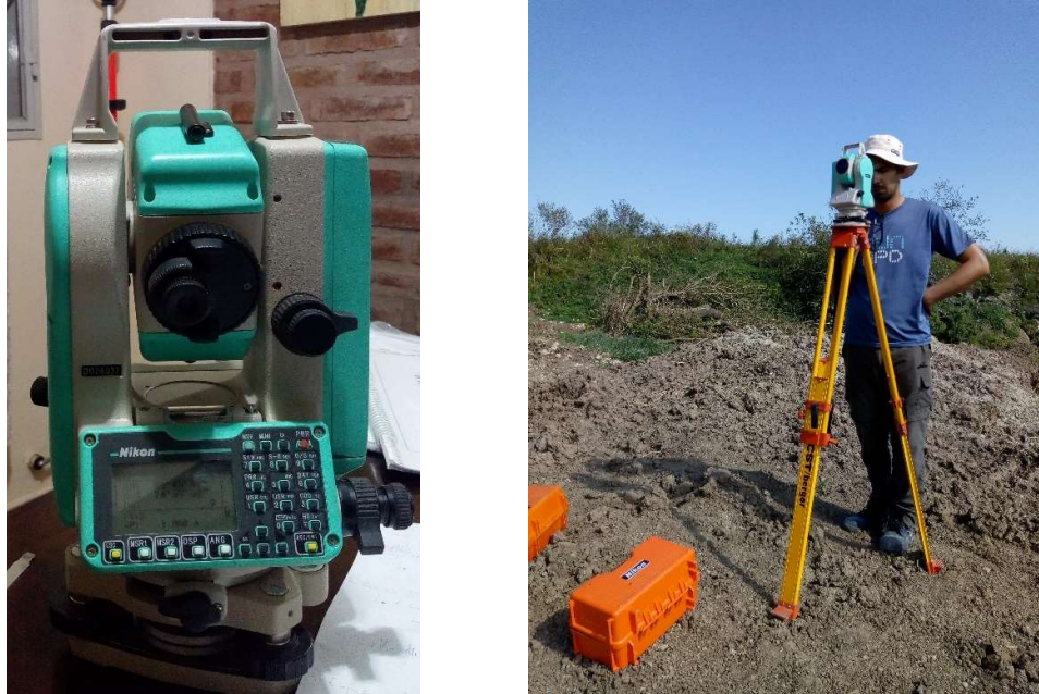
Figura 3. 2 Relevamiento topográfico con Estación Total
