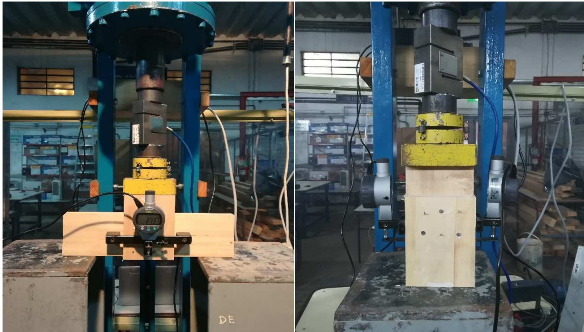
Figura 4.3: Probeta de dirección perpendicular a la izquierda y probeta de dirección paralela a la derecha, dispuestas para comenzar la prueba.
