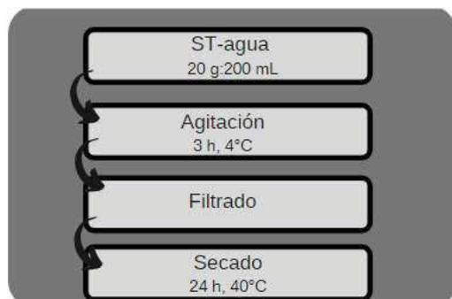
Fig. 1. Secuencia de extracción acuosa del ST
