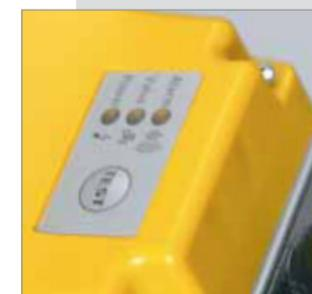
En caso de avería (salida atascada, por ejemplo) saltará el modo de alarma pasados 60 segundos, transcurridos los cuales, el ECO DRAIN sigue funcionando. Un LED intermitente avisa de la avería. Un contacto libre de potencial permite transmitir esa señal de alarma al sistema superior de mando o al controlador del compresor (a partir del ECO DRAIN 31).
