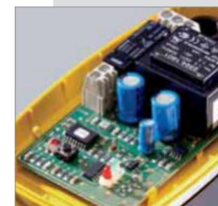
El sistema electrónico inteligente de control regula de manera exacta la apertura y el cierre de la válvula de membrana; de esta forma sólo se evacua el condensado y no escapa el aire comprimido. Así se evitan pérdidas de aire comprimido y se ahorra energía. Todos los componentes electrónicos están protegidos contra salpicaduras (IP 65, ECO DRAIN 30/31: IP54).
