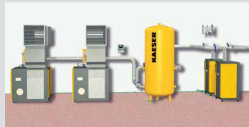
El KAESER Energy Saving System (KESS) se encarga de calcular la producción de aire comprimido óptima para su empresa aplicando lo último en procesamiento de datos. Las estaciones de aire comprimido planificadas por Kaeser se distinguen por su buen rendimiento energético. Los índices de carga de los compresores alcanzan un 95-98 %.
