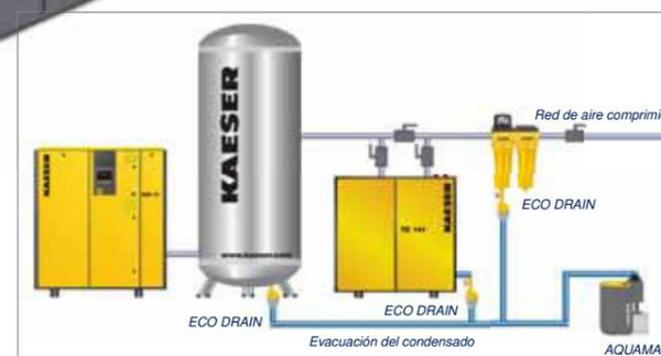
La evacuación segura de los condensados debe quedar garantizada en todos los puntos de acumulación de su sistema de aire comprimido. La mejor forma de conseguirlo es utilizar purgadores de condensados regulados electrónicamente.
