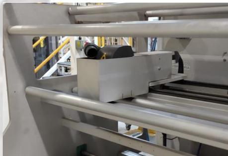
Lente de impresión con protecciones laterales montadas
