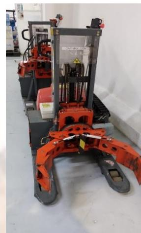
Estos equipos permiten la manipulación de la bobina, tomándola entre sus pinzas cuando la bobina está en posición vertical, y luego la giran para su montaje en la espada.
