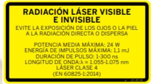
En el caso del sistema, este se trata de un equipo láser de **clase 4**. Hasta la salida del rayo láser el sistema láser cerrado se comporta en funcionamiento normal como un equipo de láser de **clase 1**
