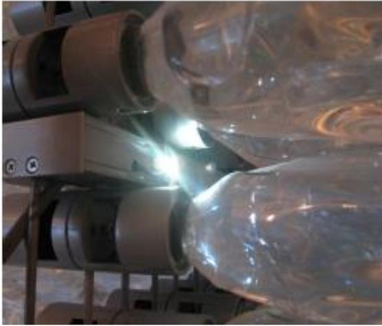
Figura 21. Anclaje de botella a la boquilla eléctrica.
