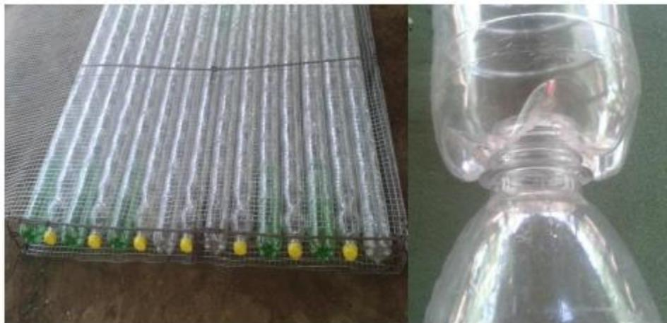
Figura N°42. Confinamiento dentro de estructura metálica (izq.). Empotramiento por el culo de la botella (der).
