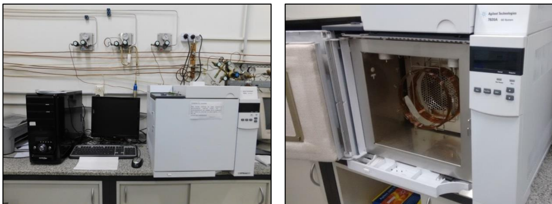
Figura 3.29: Cromatógrafo Agilent 7820A (Centro de Investigación y Tecnología Química – CITEQ, CONICET – UTN, FRC).
