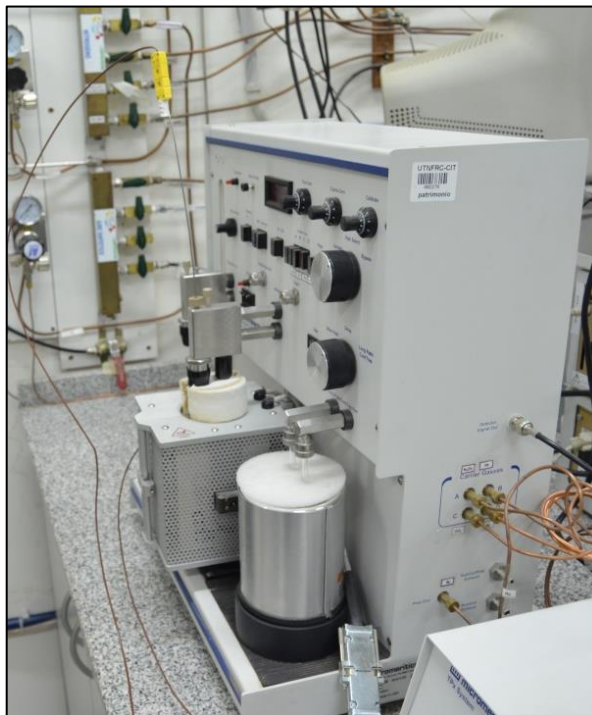
Figura 3.21: Equipo de reducción a temperatura programada ChemiSorb 2720 (Centro de Investigación y Tecnología Química – CITEQ, CONICET – UTN, FRC).
