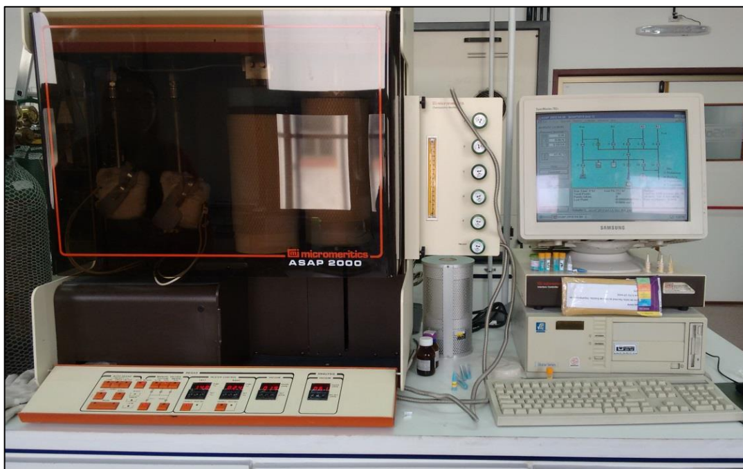
Figura 3.12: Equipo de adsorción-desorción de N_2 , Micromeritics ASAP 2000 (Laboratorio de Sólidos Porosos, INFAP-CONICET, Universidad Nacional de San Luis).
