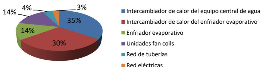
El gráfico 3 muestra los porcentajes de costos asociados a los intercambiadores de calor de tubo y coraza diseñados:
