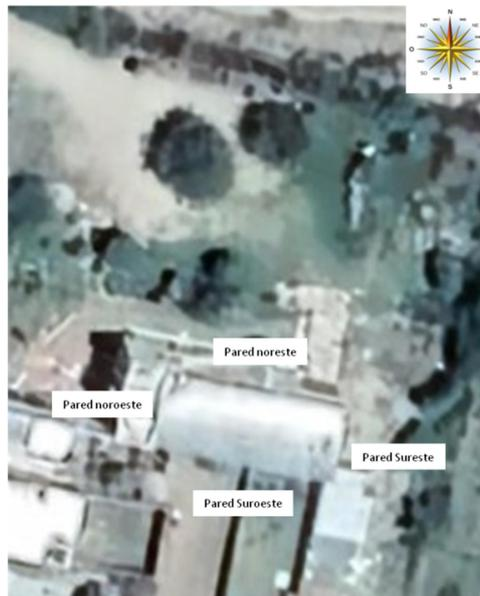
La pared noroeste es interior y divide el local de fermentación con la zona de fraccionamiento. Al no recibir directamente el impacto de la radiación solar, deberá analizarse de forma distinta. La temperatura de la zona de fraccionamiento se mantiene en  $21\text{°C}$ . El material de construcción de la pared es el mismo que las paredes exteriores.
