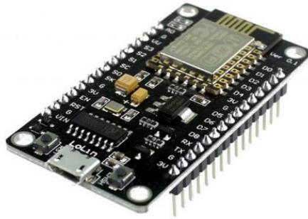
Ilustración 2 - Placa Arduino NodeMCU
