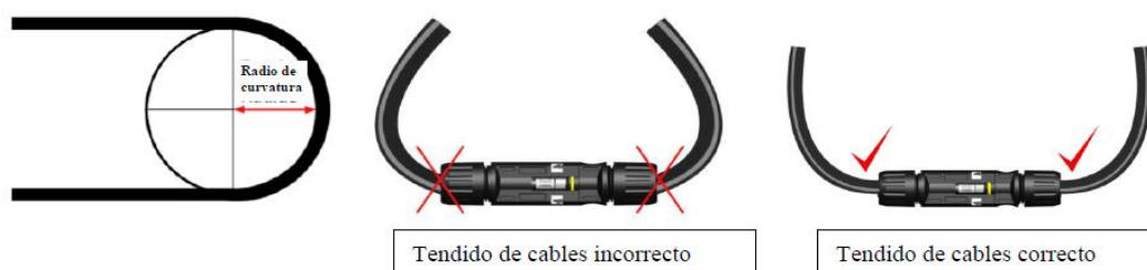
Ilustración 22 - Recomendación para instalación cable solar
