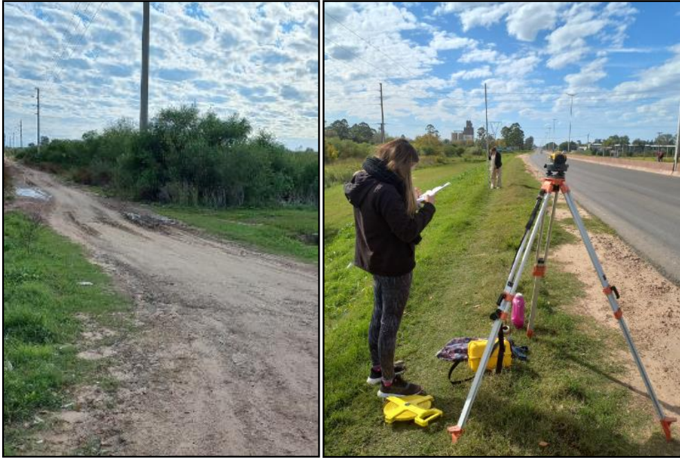
Figura 70. A la izquierda Calle Pública donde se inició el relevamiento día 1. A la derecha nivelación sobre RPN°39 día 1. Fuente: Propia.
