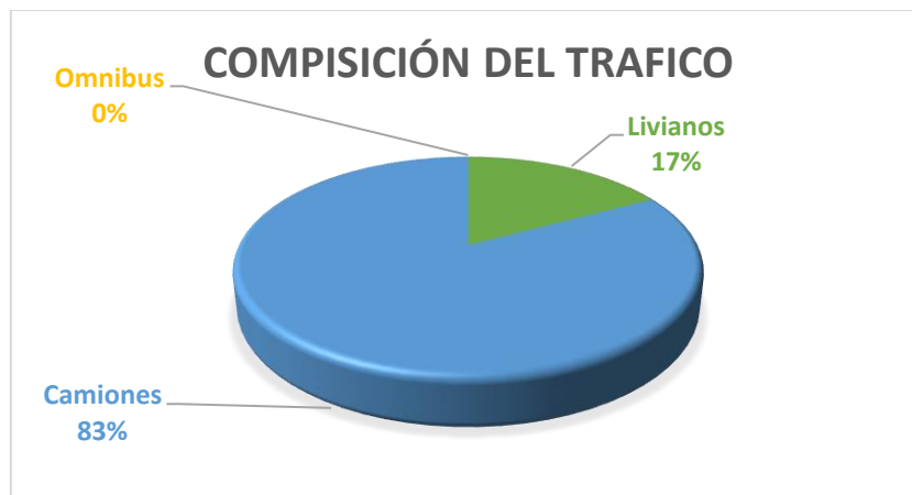
Gráfico 18. Porcentaje de TMDA correspondiente a cada tipo de vehículo, conteo calle Pública N°1165. Fuente: Propia.
