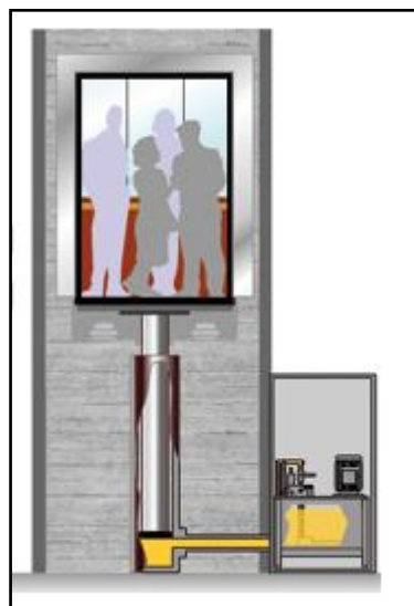
Figura 222. Ascensor, sistema hidráulico. Fuente: http://blog.gmveurolift.es/funcionamiento-de-un-ascensor-hidraulico/
