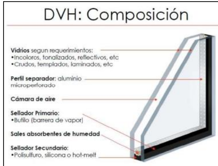
Figura 193. Detalle de abertura de aluminio DVH. Fuente: https://ralaluminio.com.ar/
