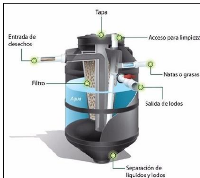
Figura 209. Funcionamiento del biodigestor autolimpiable Rotoplas. Fuente: Rotoplas.
