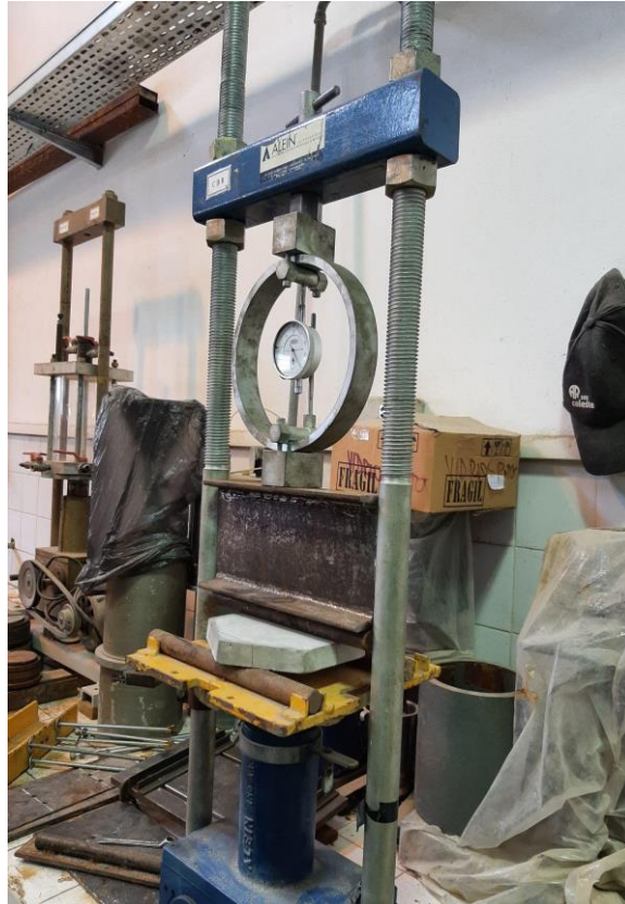
Imagen 39: Probeta de hexágono en su ensayo de flexión.
