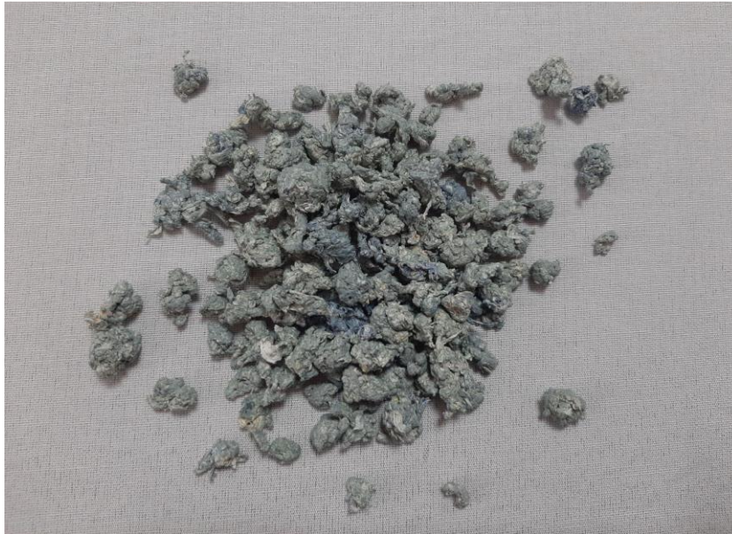
Imagen 31: Polipropileno agrumado y molido
