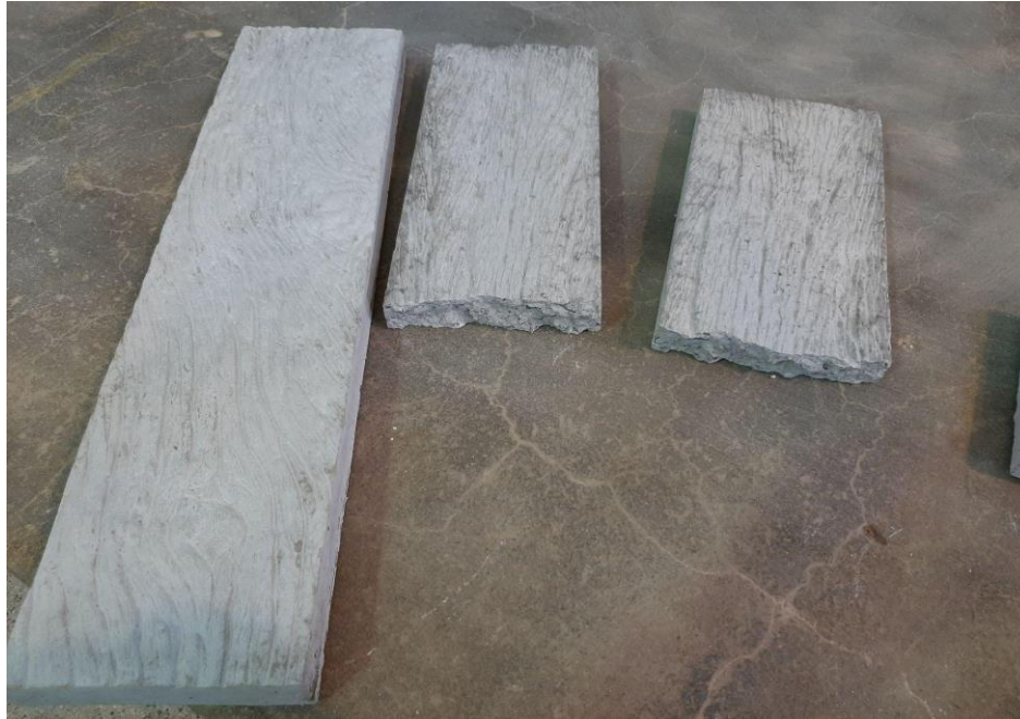
Imagen 38: Probeta de tricapa (primera) y probeta de hormigón convencional (segunda) luego del ensayo de choque.
