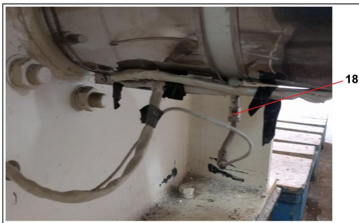
Fig. 2.34: Área de salida de material. 18-Termostato del tornillo sinfín.
