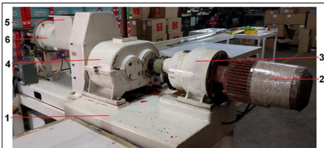
Fig. 2.44: Procesadora. 1-Bastidor, 2-Motor eléctrico, 3-Caja de velocidades, 4-Reductor de velocidad, 5-Punto de ingreso de material, 6-Punto de salida de material.
