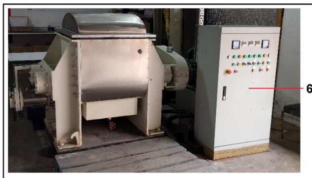
Fig. 2.42: 6-Tablero de comandos y señalizaciones.
