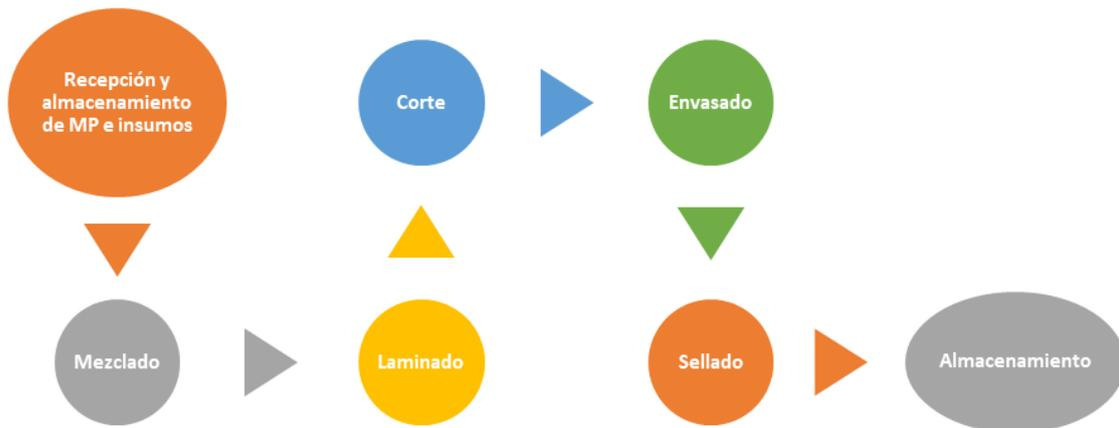
Fig. n°20 Proceso de producción: discos de masa
