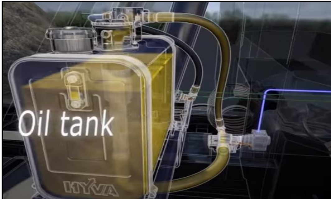
Figura 8.18 – Accionamiento de la bomba y recirculación del aceite al tanque
