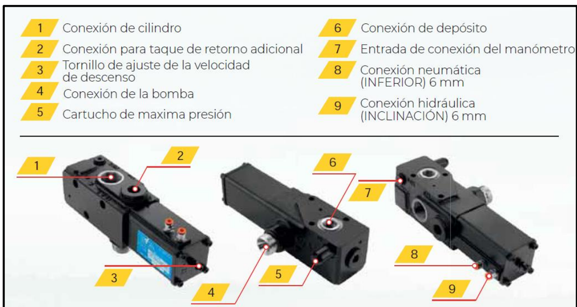
Figura 8.6 – Válvula direccional hidráulica
