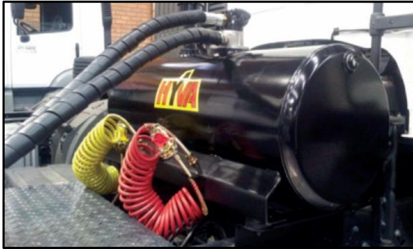
Figura 8.5 – Depósito de aceite
