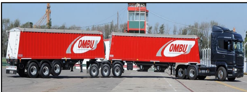
Figura 1.10 – Bitren tipo tolva
