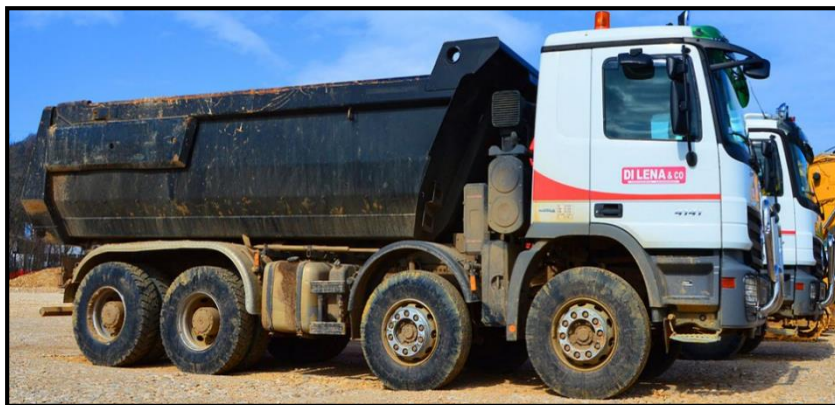
Figura 1.5 – Camión volquete Europeo de 4 ejes
