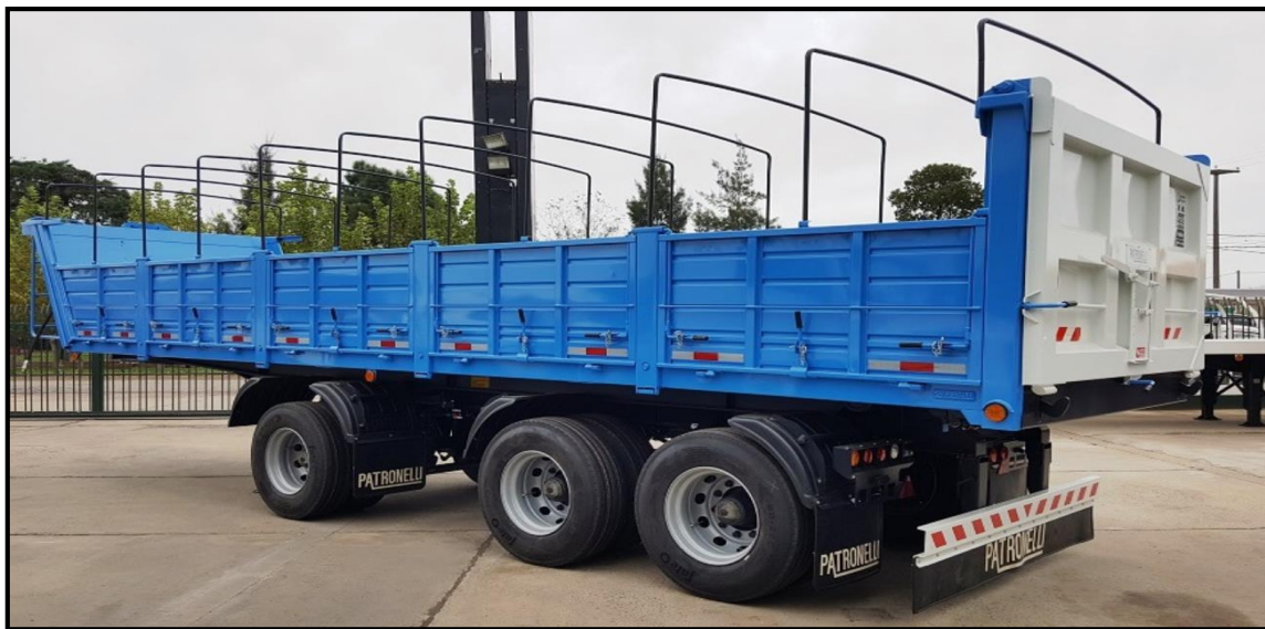
Figura 1.15 – Batea vuelco trasero con barandas
