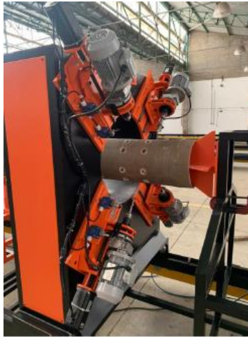
Figura 34: Perforadora Puncher Fuente: Presupuesto otorgado por Korthfiber
