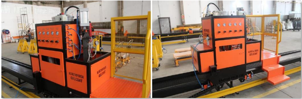
Figura 36: Aplicador de Gel-Coat Fuente: Presupuesto otorgado por Korthfiber
