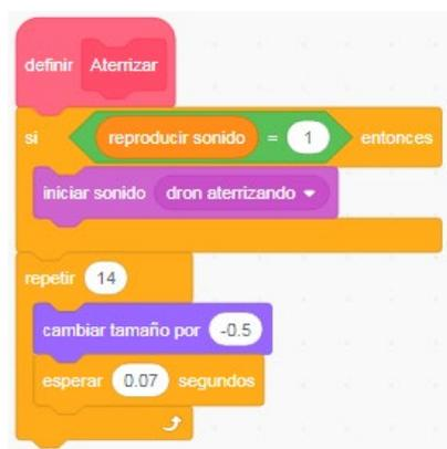
Figura 3: Procedimiento para aterrizar el Drone.
