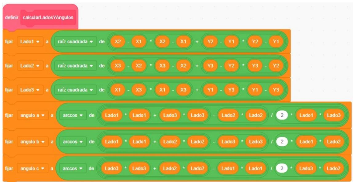
Figura 44: Procedimiento para calcular los lados del triángulo.
