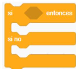
Figura 28: Condicional compuesto en Scratch.
