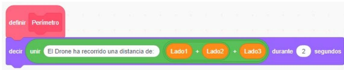
Figura 46: procedimiento del cálculo del Perímetro en Scratch.
