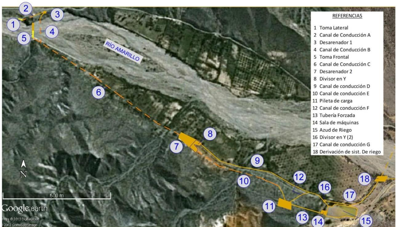
Ilustración 51 - Imagen Satelital de la Infraestructura abarcada por la Mini Central Hidroeléctrica
