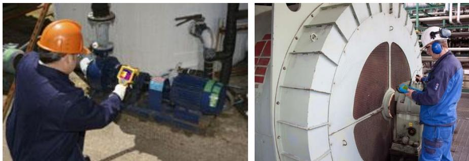
Ilustración 55 - Ejemplos de mantenimiento de rodamientos
