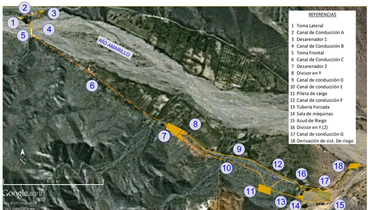
1. Toma Lateral: realiza la captación del agua proveniente del río Amarillo. Consiste en una rejilla de hierro sobre el lecho lateral del río, controlada por una compuerta mecánica que habilita o no el paso, por medio de un canal, al desarenador 1.
