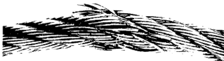
Figura 12 - Rotura de hilos en zona de poleas, acompañada de marcada deformación. Descartar inmediatamente.
