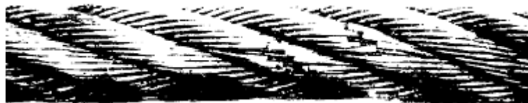
Figura 12 - Rotura de hilos en zona de poleas, acompañada de marcada deformación. Descartar inmediatamente.
