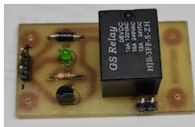
Fig. N° 37-Placa física comando motor.
