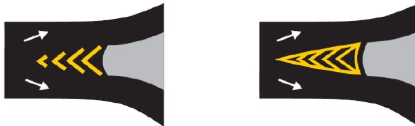
H. 8 MARCAS CANALIZADORAS DE TRÁNSITO E ISLETAS PARA CIRCULACIÓN UNIDIRECCIONAL (Advierten la presencia de obstáculos)
