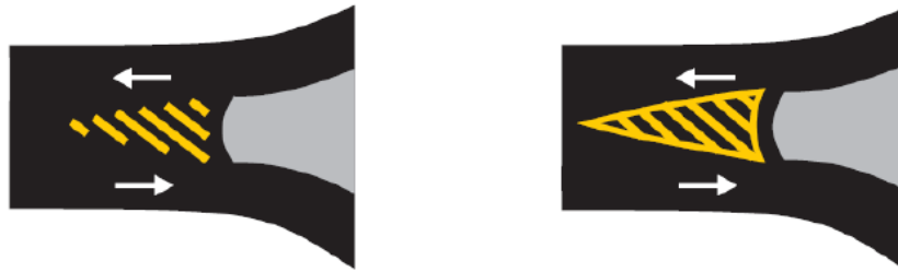
H. 8 MARCAS CANALIZADORAS DE TRÁNSITO E ISLETAS PARA CIRCULACIÓN BIDIRECCIONAL (Advierten la presencia de obstáculos)
