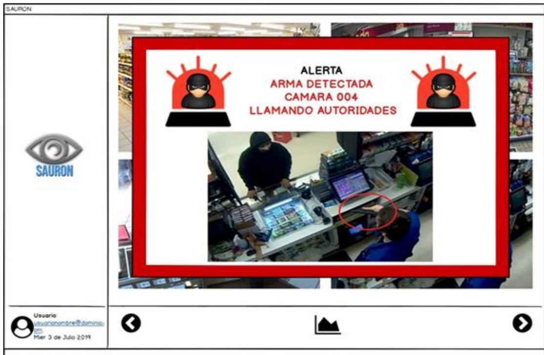
FIG. N°26. MOCK UP INTERFAZ DE USUARIO: VISTA DE ALERTA POR ARMA DETECTADA V1.0 - SE MOSTRARÁ UN CARTEL LLAMATIVO Y CON COLORES DE ALARMA, PARA PREVENIR AL CLIENTE QUE SE DETECTÓ UN ARMA Y QUE YA SE LE INFORMÓ A LOS AGENTES DE SEGURIDAD.
