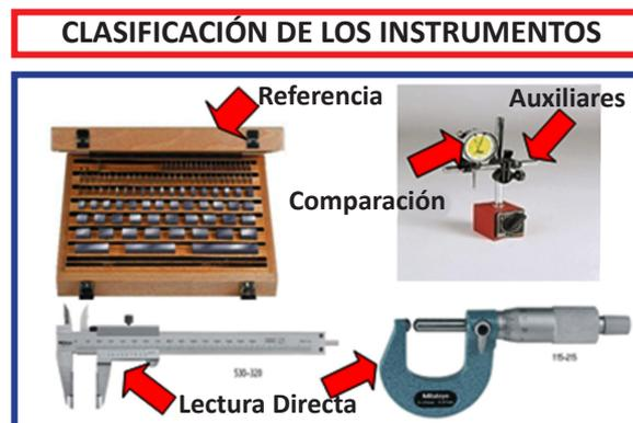
Fig. 5.6 - Ejemplos de clasificación de los instrumentos
