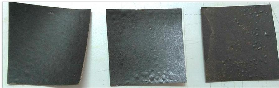
**Figura 4.** Formación de ampollas: LPF<sub>2</sub>, LPF<sub>3</sub> y LPF<sub>4</sub> (de derecha a izquierda).
