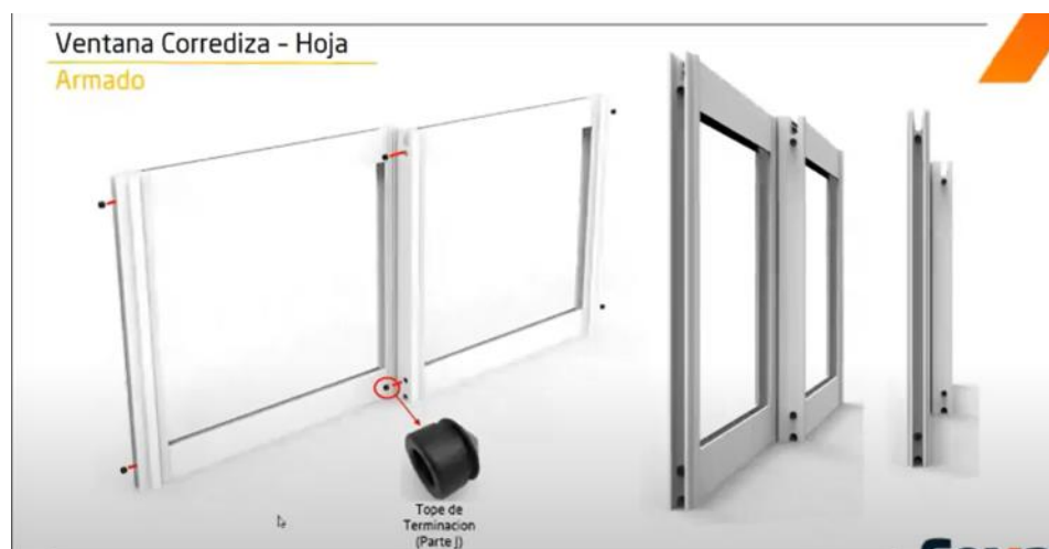
Figura 18. Hojas de ventanas terminadas
