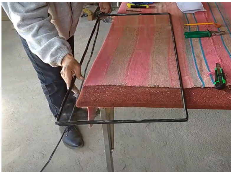
Figura 12. Paso 1: Proceso de colocación de burlete.
