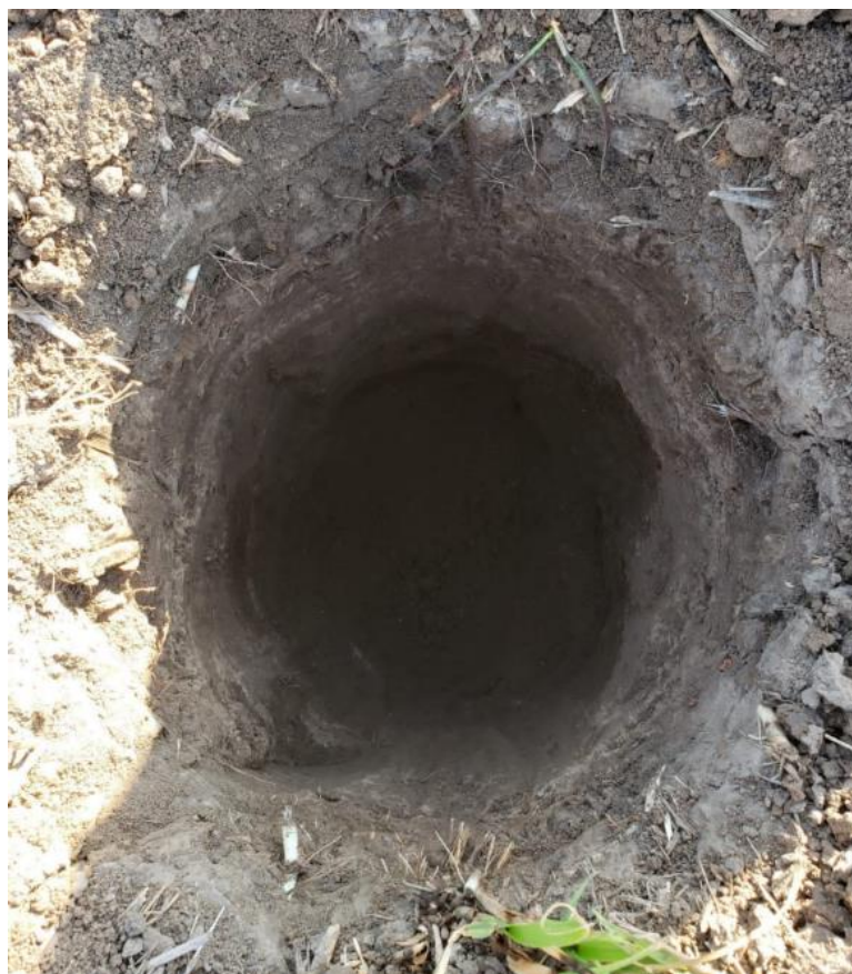
Figura 4.3. Excavación para extraer muestras.
