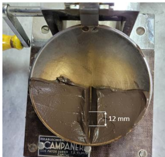
Figura 4.7. Muestra de suelo que ha cerrado (12 mm).
