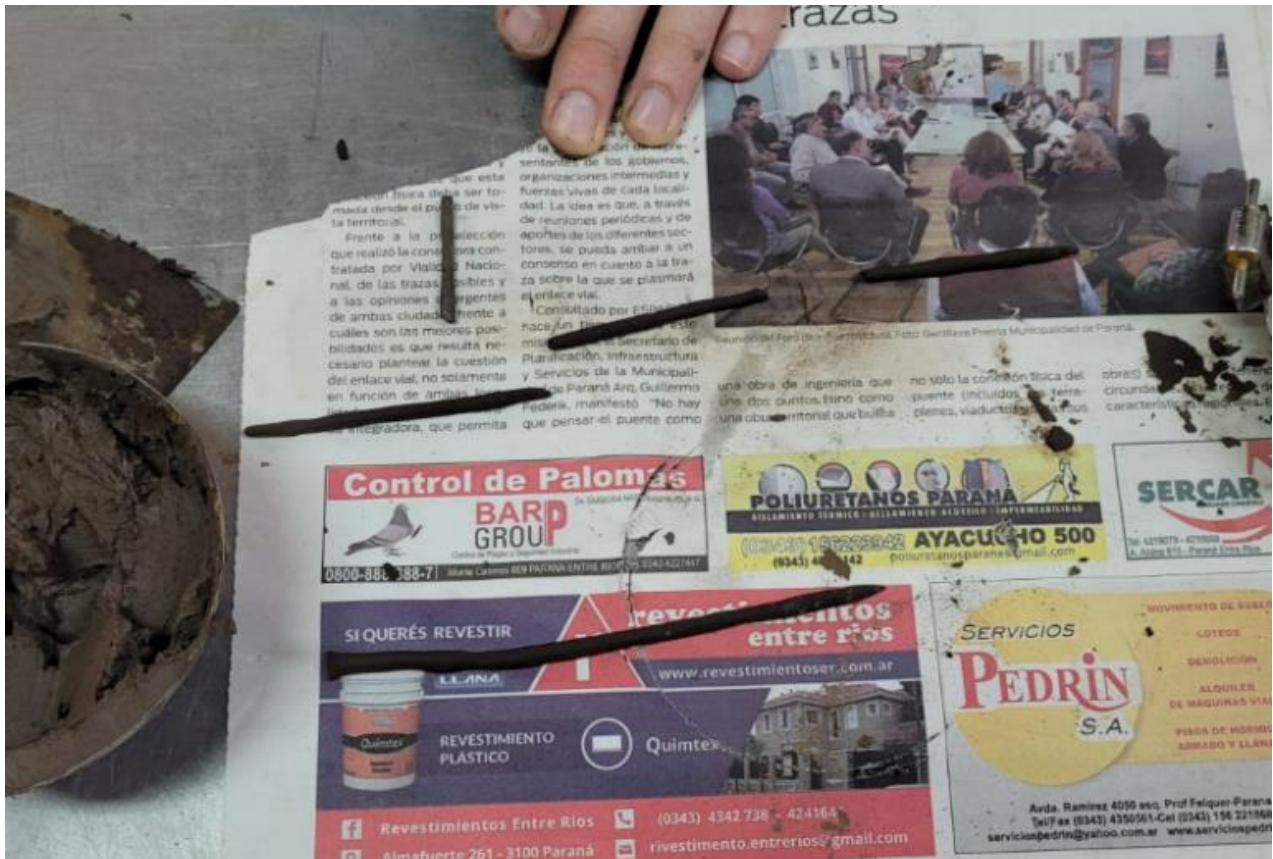
Figura 4.8. Cilindros de suelo amasado de 3 mm de diámetro.
