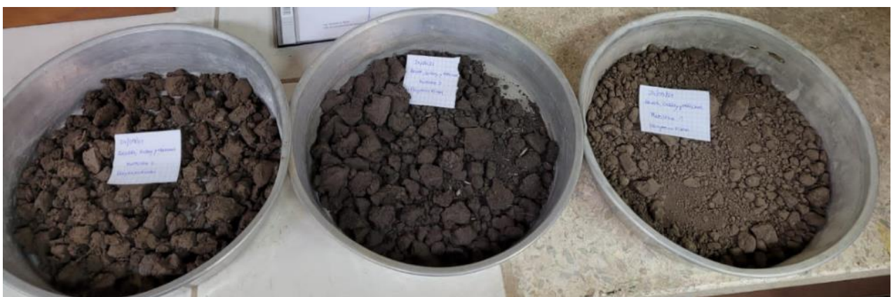
Figura 4.5. Muestras luego de 24 horas en estufa.
