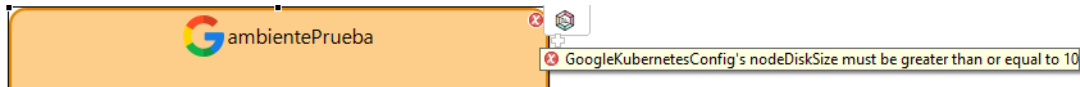
Figura 21. Mensaje de error cuando el tamaño de disco es menor a 10 GB.
